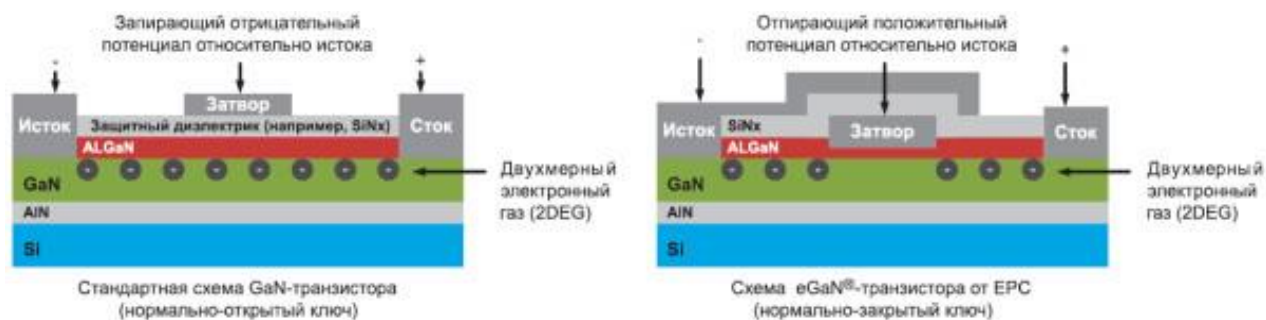
Рисунок 3 – Традиционная ячейка а) GaN-транзистора и б) eGaN® FET производства EPC
