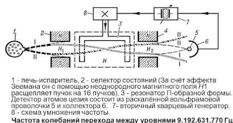
Рисунок 1 - Схема атомно-лучевых цезиевых часов
