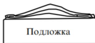
Рисунок 2 – Схематическое изображение многослойного диэлектрического зеркала
