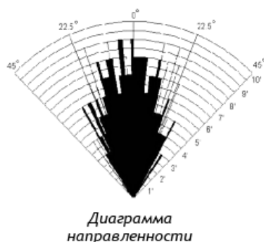
Рисунок 3 – Диаграмма направленности ультразвукового дальномера
